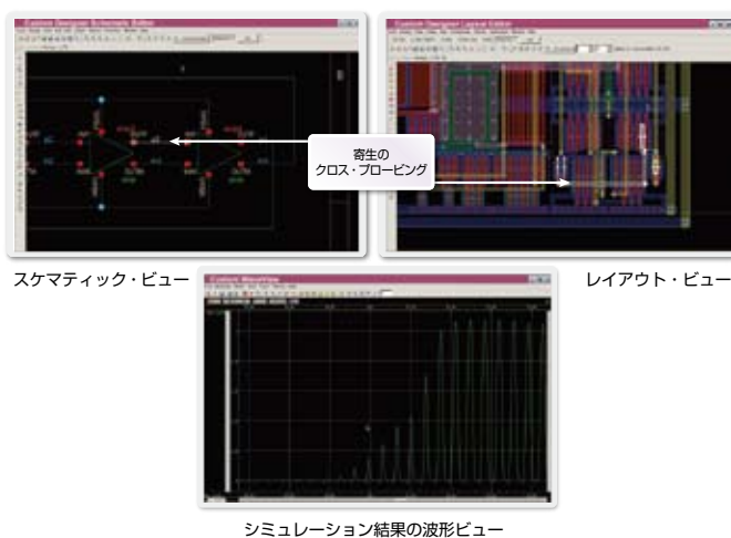
図6：StarRC CustomとGalaxy Custom Designerとの統合は、生産性の高いクロス・プロービングやシミュレーション・デバッグを実現
